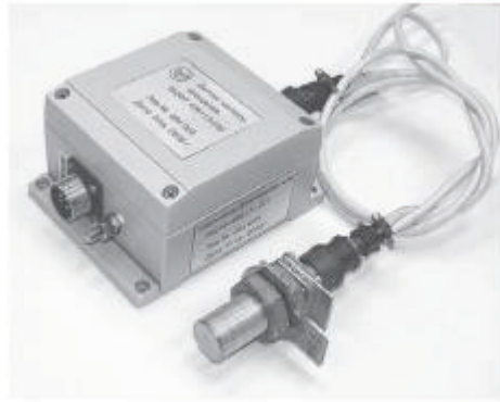
Датчик частоты вращения ИЦФР.408113.030: 1 – индуктор ИКЛЖ.408113.001; 2 – УФ ИЦФР.468171.001; 3 – жгут питания ИЦФР.685621.067; 4 – жгут ИЦФР.685621.068
