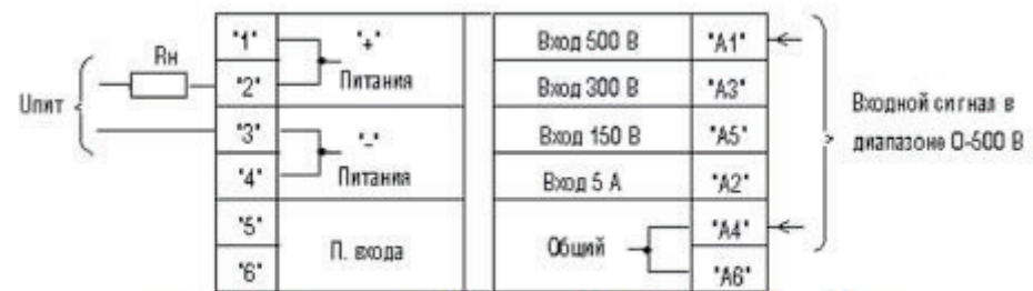
Рис. 1.1. Пример подключения для диапазона U_{из} 0–500 В
