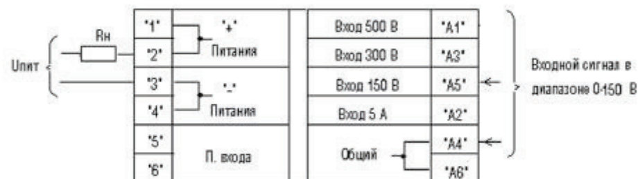
Рис. 1.3. Пример подключения для диапазонов U_{\text{вх}} 0–150 В
