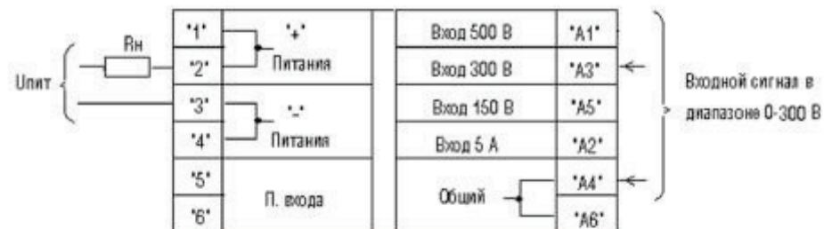
Рис. 1.2. Пример подключения для диапазонов U_{\text{вх}} 0–300 В
