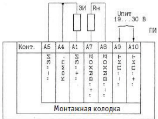
Рис. 4.1. Схема подключения ПИ
